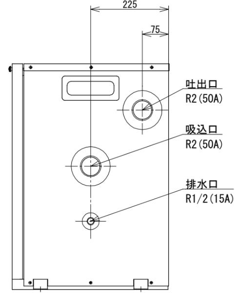
※ 各配管接続口には必ずバルブを設けて下さい。
