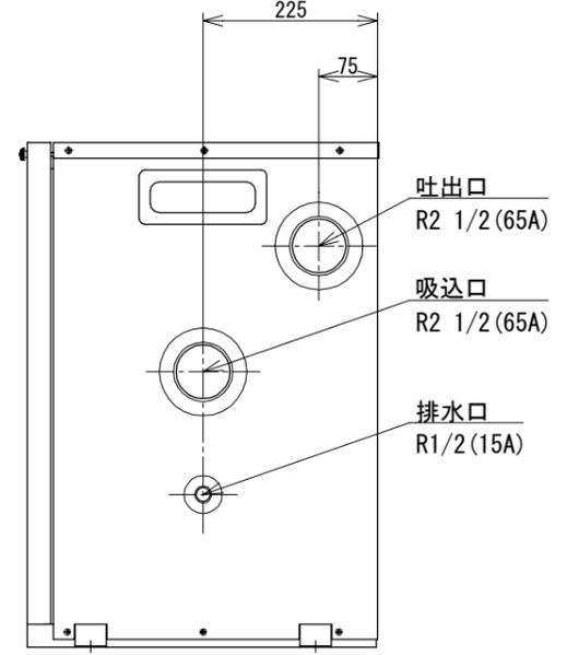
※ 各配管接続口には必ずバルブを設けて下さい。
