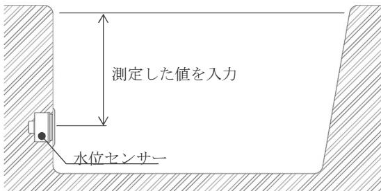
浴槽のセンサー中心から水面までの高さを測定します。
