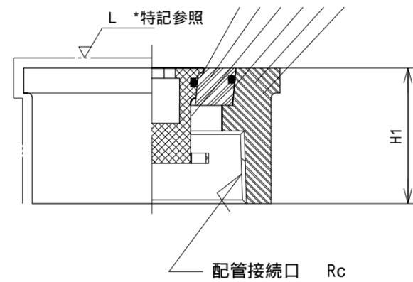
\* 型式の数字が配管接続口の呼び径です。
